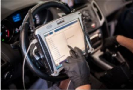
2024年10月から、車検に電子装置の検査「OBD(On-Board Diagnostics 車載式故障診断装置)」検査が追加された。対象は2021年10月以降の新型(フルモデルチェンジ)の乗用車、バス、トラック。輸入車は2022年10月以降の新型車で、検査開始は2025年10月以降の車検において実施される。
